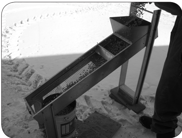
Figure 4. Un grillage incliné de fabrication artisanale permet de retirer le son et les particules fines du maïs égrené avant de le brûler. Ce nettoyage doit se faire à l'extérieur afin de ne pas empoussiérer la maison.
