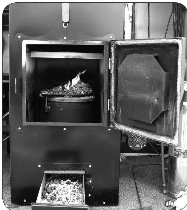
Figure 8. Brûleur à maïs alimenté par le fond. Le maïs brûlé est forcé vers le haut et finit par tomber dans le cendrier.
