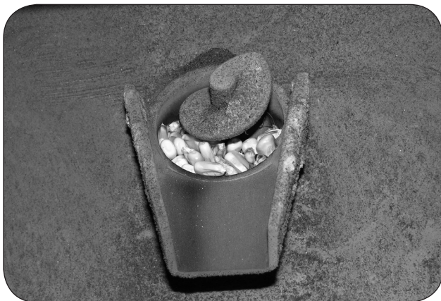
Figure 5. Vue de l'intérieur du poêle de la vis sans fin servant à y introduire le combustible. La vitesse et la mise en marche de la vis sont réglées par les commandes du poêle. Le maïs égrené tombe de l'entonnoir situé sous la goulotte de la vis sans fin dans la chambre de combustion.
