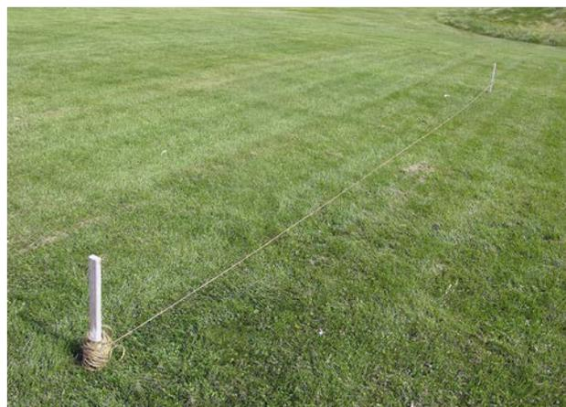
**Figure 3-1.** Méthode d'échantillonnage par transect : on voit ici une ligne de 10 m de long tracée au hasard dans le gazon.
