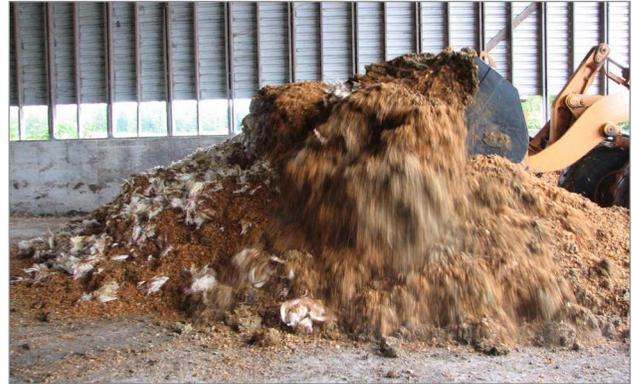
**Figure 2.** Retournement d'un tas de compost constitué d'un mélange de cadavres de volailles et de substrat avant de le placer en andains.
