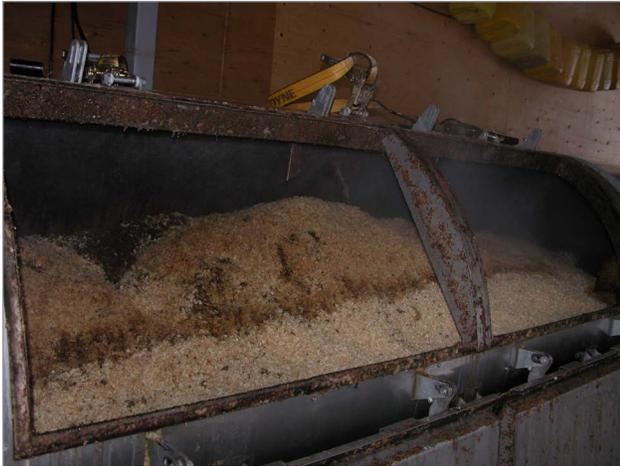
**Figure 5.** Système de compostage dans un bac de compostage.
