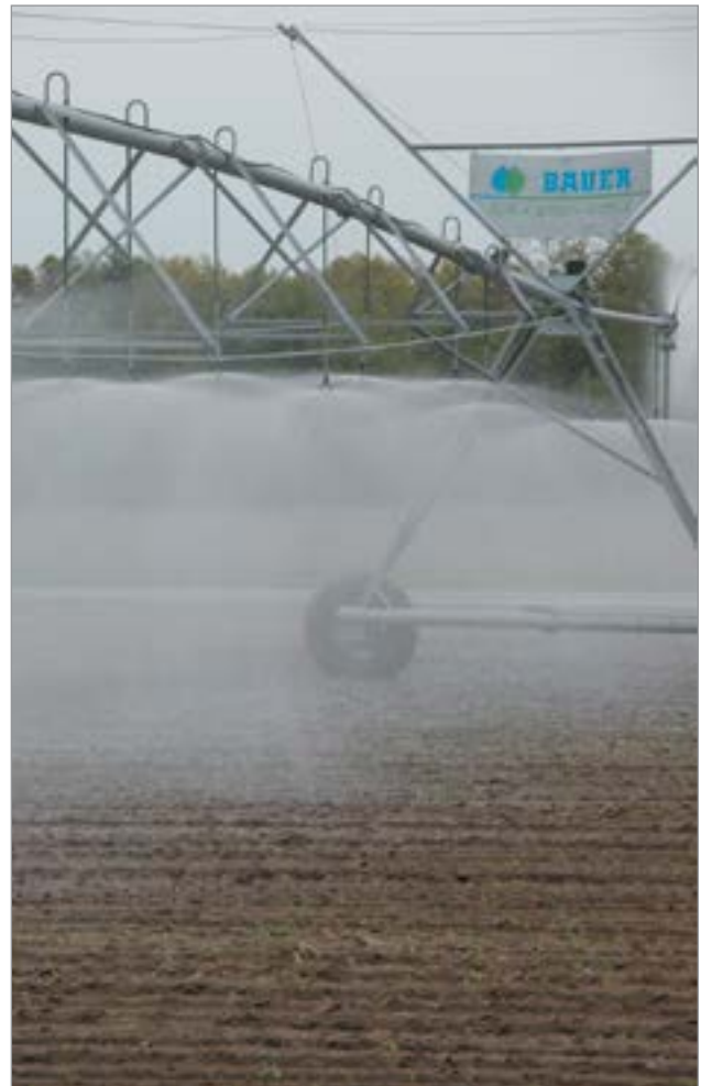
Figure 1. Système d'irrigation à basse pression et à déplacement latéral
