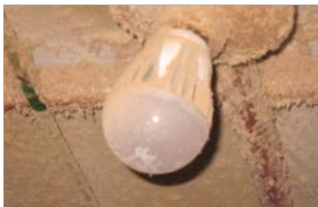
Figure 7. Ampoule à DEL de style Edison avec des ailettes de dissipation de chaleur couvertes d'une couche de poussière isolante.
