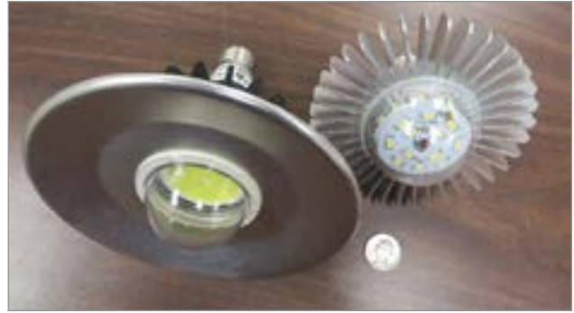
Figure 3. Ampoule à DEL hybride (à droite), sur laquelle le dissipateur thermique intérieur est apparent. Source : National Poultry Technology Center, Université d'Auburn (États-Unis), www.poultryhouse.com .
