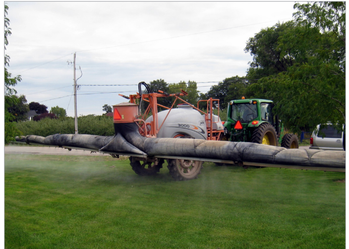
Figure 9. Rampe horizontale munie d'un manchon à air.
