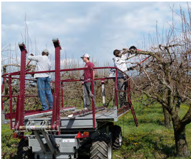
Figure 5. Plate-forme permettant d'augmenter l'efficacité des ouvriers et de réduire la nécessité de recourir à des échelles.
