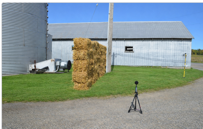
Figure 6. Un écran en balles de paille placé à 4,35 m (14 pi) d'un ventilateur d'aération axial de cellule à grains a réduit le bruit de 10 à 12 dB [5] dans la zone juste de l'autre côté du mur de balles.
